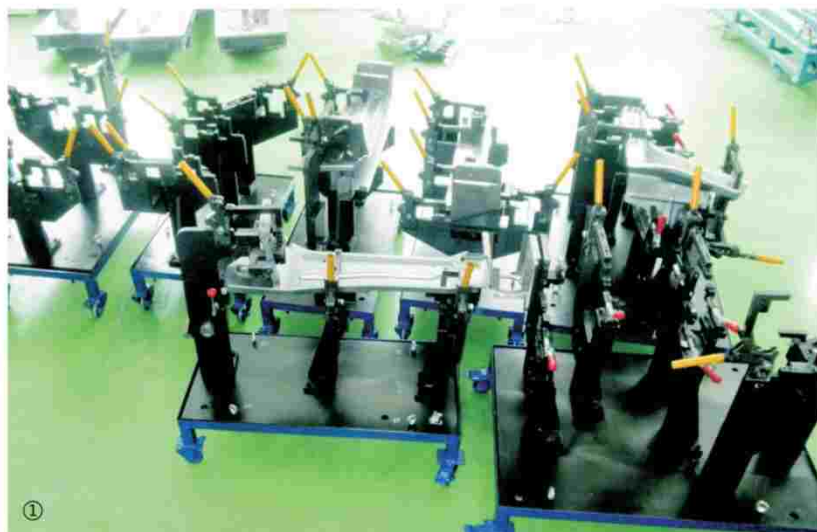
①車葉子板焊接夾具
